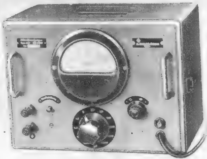
Bild 5. Mikrofaradzeiger für Kapazitäten bis 5000 µF
